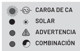
Figura 18: LED 1: la carga de CA está encendida
