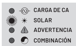
Figura 19: LED 2: la carga solar está encendida
