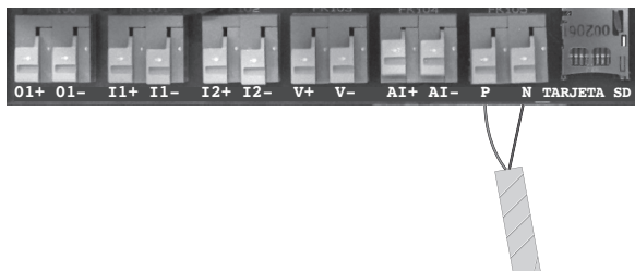
Figura 19 - Ejemplo de conexión de RS-485
